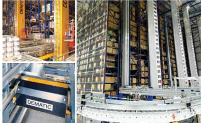
*El Dematic Multishuttle amplía la gama de aplicaciones posibles con sistemas de almacenes automatizados, permitiendo el desarrollo de una gama de soluciones automatizadas completamente nueva.*
