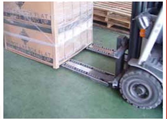
**Push Pull:** Mordaza telescópica para movimiento de cargas con slip sheets
